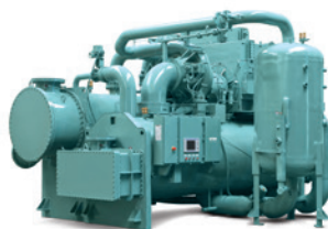
CYK HP Pompa di calore acqua/acqua Compressori dual-centrifughi, Disposizione in serie / R1234ze Acqua calda fino a 93°C Cap. riscaldamento.: 4.000 a 10.000 kW
