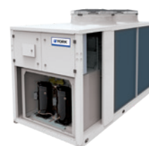
YLZ P. calore aria/aria E.V.I Sistemi 4 tubi Scroll E.V.I / R410A Acqua calda fino a 65°C Cap. di riscaldamento: 24 a 210 kW
