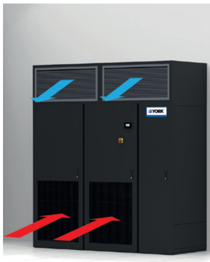
Presa d'aria frontale e uscita d'aria frontale con plenum di distribuzione a griglie orientabili.
