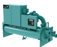
YMC² P. calore acqua/acqua VSD Centrifugo a cuscinetti magnetici / R513A Acqua calda fino a 65°C Cap. di riscaldamento: 1600 a 3000 kW
